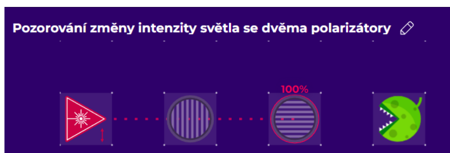
Obr. C.2: Pozorování změny intenzity světla se dvěma polarizátory: 2. polarizátor otočen o 90^\circ .
