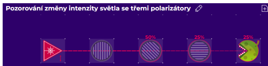
Obr. C.4: Pozorování změny intenzity světla se třemi polarizátory: prostřední polarizátor otočen o 45^\circ .
