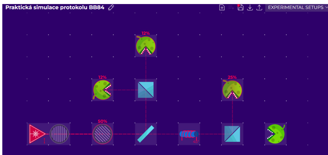
Obr. C.6: Praktická simulace protokolu BB84: polarizátor otočen o 45^\circ .
