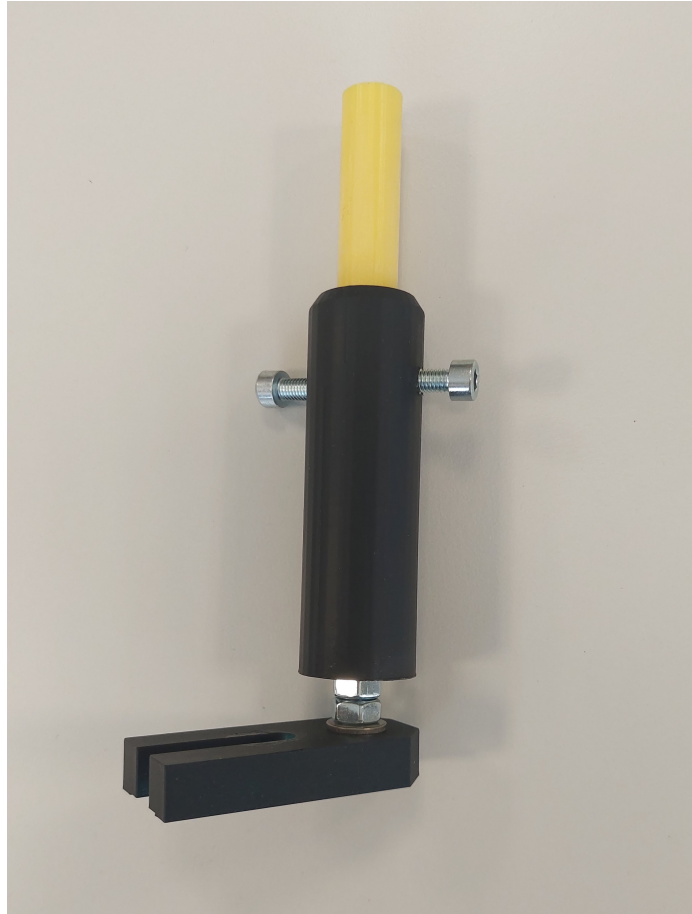
Obr. 7.4: Držák sloupku, sloupek a montážní základna.
