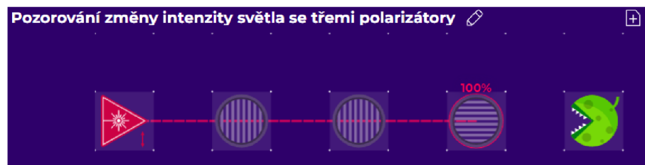
Obr. C.3: Pozorování změny intenzity světla se třemi polarizátory: prostřední polarizátor otočen o 0^\circ .
