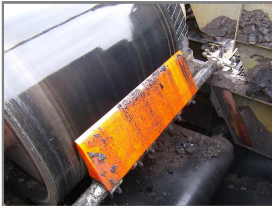
Obr. 3 Stěrač pásových dopravníků [6]
