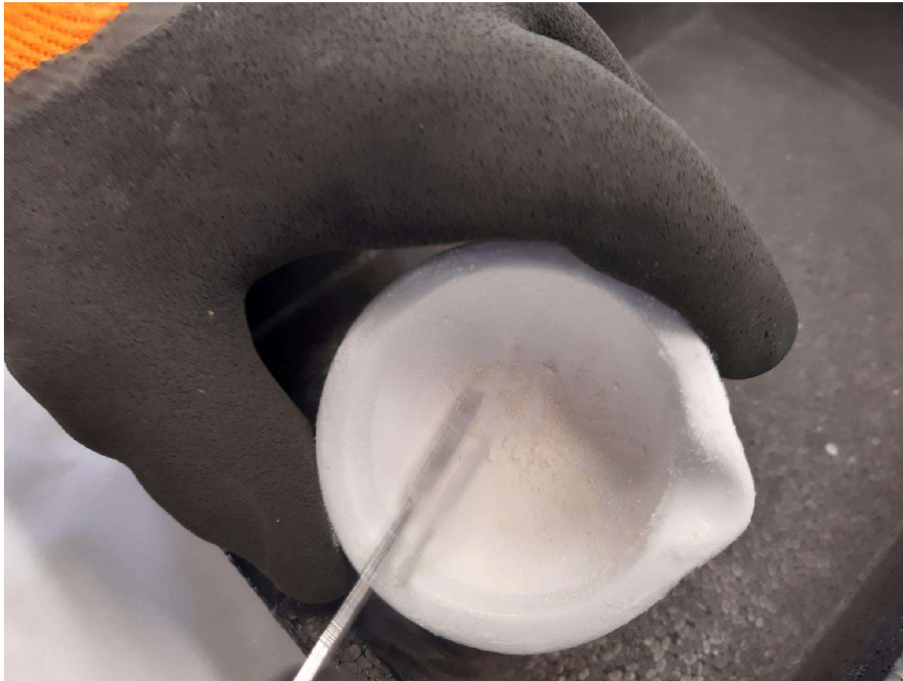
Příloha 3: Kvantitativní převedení jemného prášku do centrifugační zkumavky
