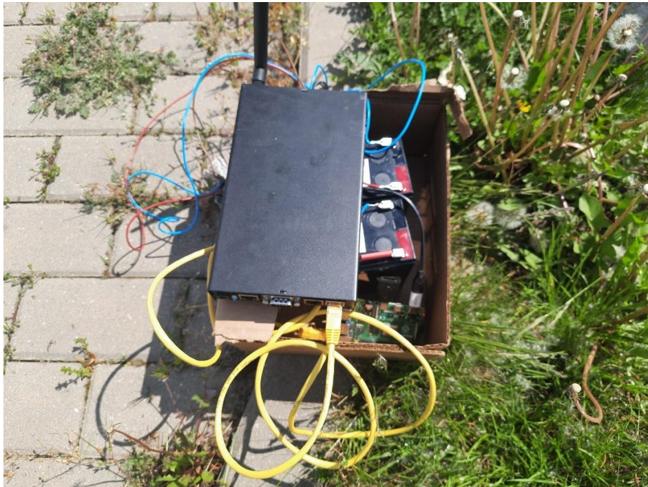
Obrázek 4.3 Server měřicího systému (Raspberry Pi) připojený k přijímači mobilního robota
