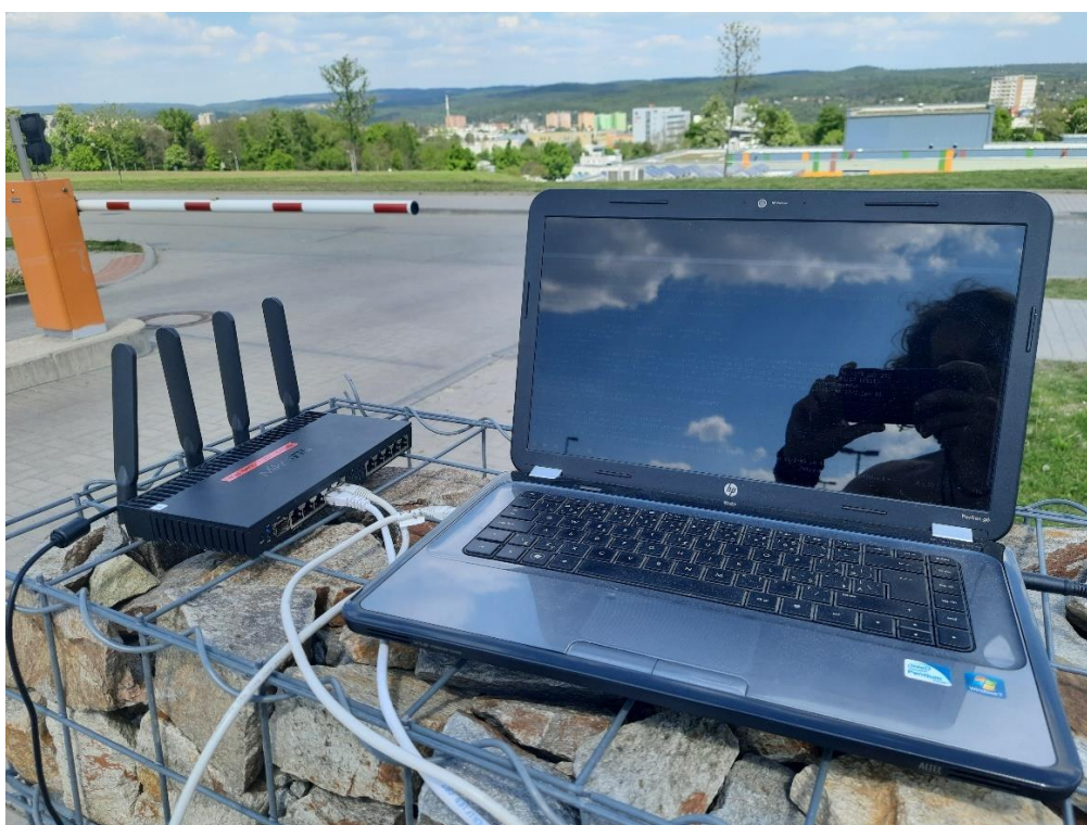
Obrázek 4.2 Klient měřicího systému (notebook) připojený k řídicí stanici
