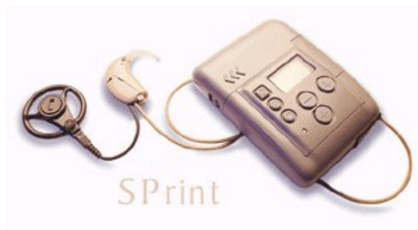
Obrázek 14. Kochleární implantát, složení – vnější část
