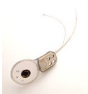
Obrázek 14. Kochleární implantát, složení – vnější část
