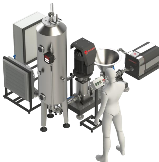
Obr.22 Ukážka pilotného kavitačného zariadenia od firmy CT Systems na extrakciu etanolu z bylín [12]
