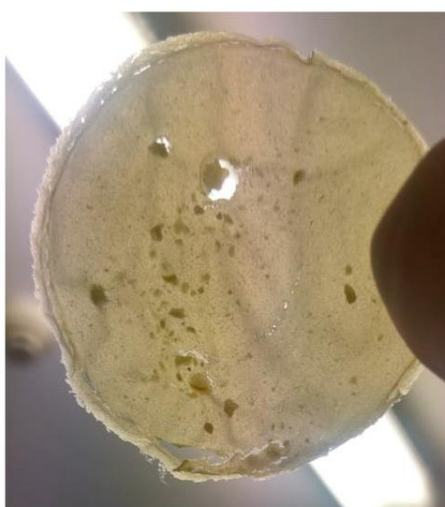
Obr.26 Disk z citrónovej “CytoCell” vyrobený pozvoľným sušením vodnej pasty [34]
