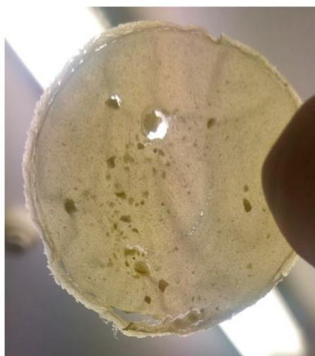
Obr.26 Disk z citrónovej “CytoCell” vyrobený pozvoľným sušením vodnej pasty [34]
