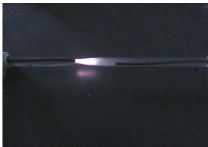
Obr.34 Plazmový výboj generovaný v kavitačnom mraku + detail systému elektród [41]
