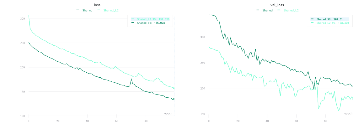
Obr. 5.9: Porovnanie hodnôt stratových funkcií počas tréovania modelu Shared s a bez L2 regularizácie.
