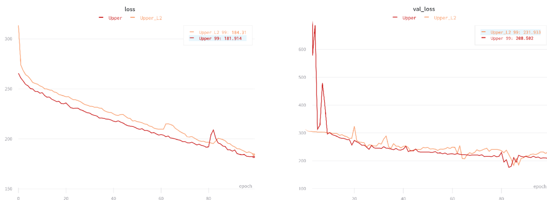
Obr. 5.8: Porovnanie hodnôt stratových funkcií počas tréningovania modelu Upper s a bez L2 regularizácie.
