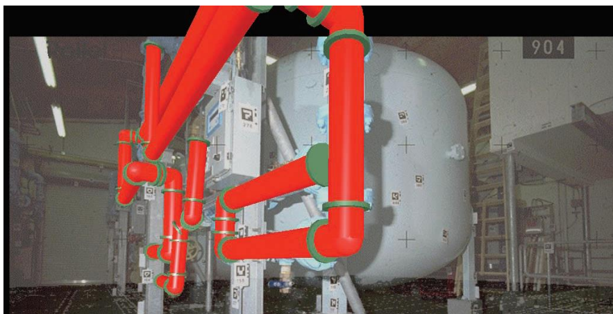
Abbildung 18: Rohrleitungen Design in AR [39]
