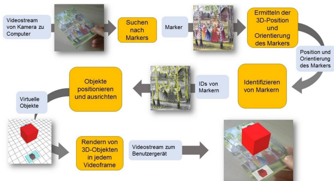
Abbildung 11: Prinzip des optischen Kamera-Trackings [9]
