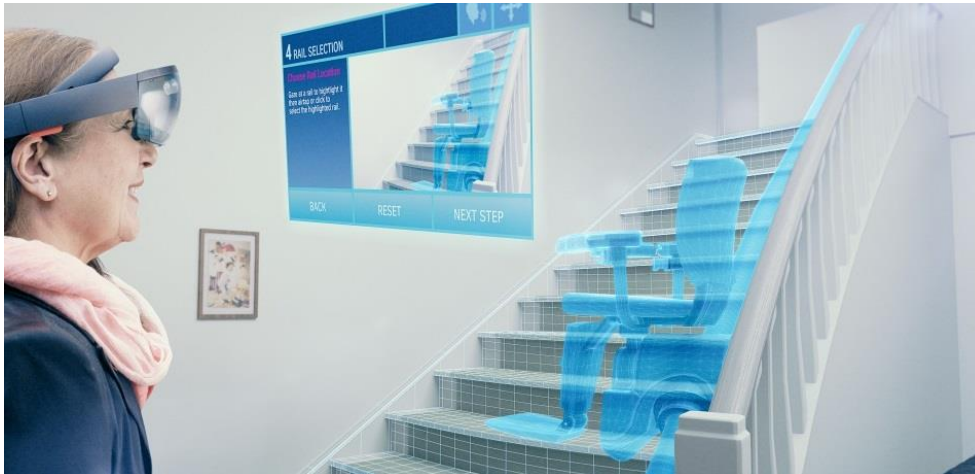
Abbildung 16: Design von Treppenlift mit Hilfe von AR [88]
