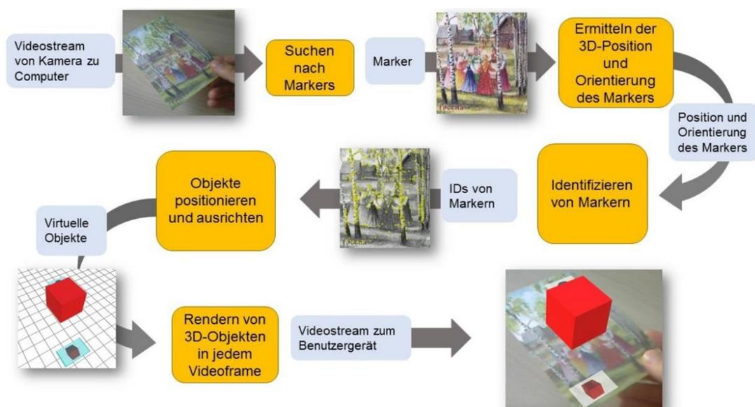
Abbildung 11: Prinzip des optischen Kamera-Trackings [9]
