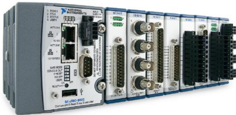
Obrázek 4.1 – cRIO v šasi s 8 sloty plně zaplněné C-moduly [24]
