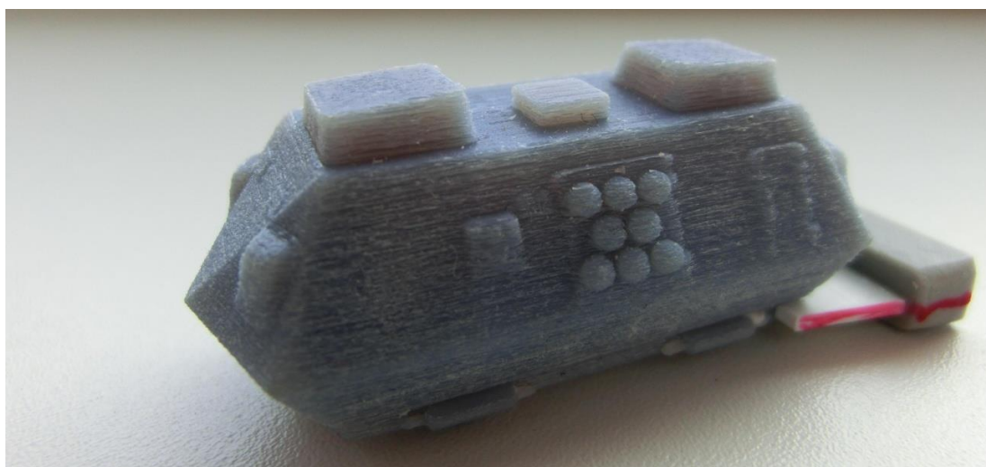
Obr. 25 Výsledný prototyp vyrobený strojem Objet30 Pro (k podvozku je připevněn nálietek).
