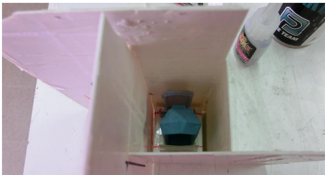
Obr. 35 Zarámovaná soustava připravená k zalití hmotou formy.
