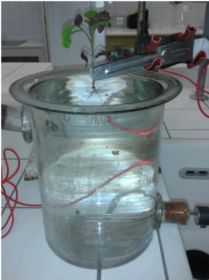
Obrázek 10: Uchycení rostlin pro stanovení elektrické kapacity kořenového systému (vlastní foto)
