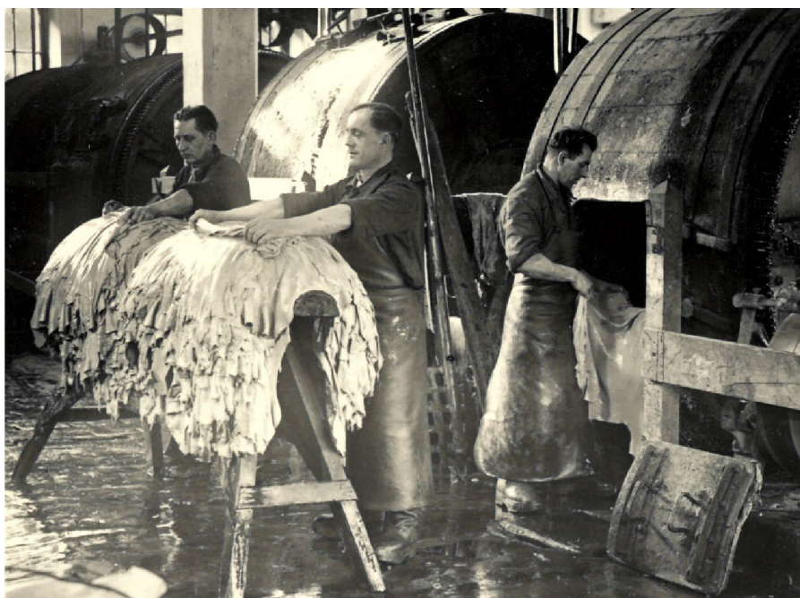
12. Továrna bratří Vitoušků, tabulové vyrážení neboli roztahování usní. Fotoalbum Vitouškovy továrny z roku 1942, TMB, inv. č. 3/2016.
