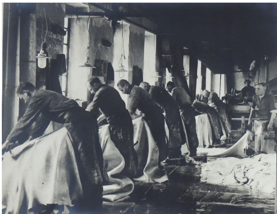
10. Továrna bratří Vitoušků, na koželužském špalku se kůže z lícové strany zbavovala chlupů a z rubové strany mázdry. Fotoalbum Vitouškovy továrny z roku 1942, TMB, inv. č. 3/2016.
