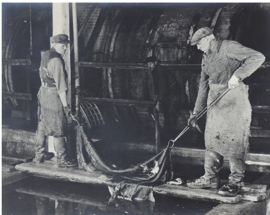
9. Továrna bratří Vitoušků – namáčení, při kterém se kůže zbavovaly nečistot. Fotoalbum Vitouškovy továrny z roku 1942, TMB, inv. č. 3/2016.
