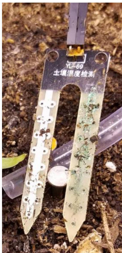
Obrázek 20 Korozí zničený odporový senzor vlhkosti (45)
