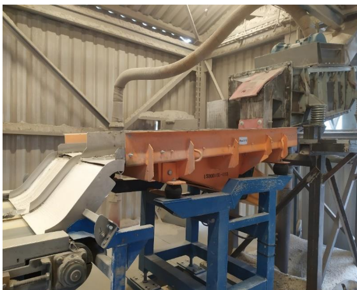
Obrázek 16: Síto S4 a vibrační podavač před separátory
