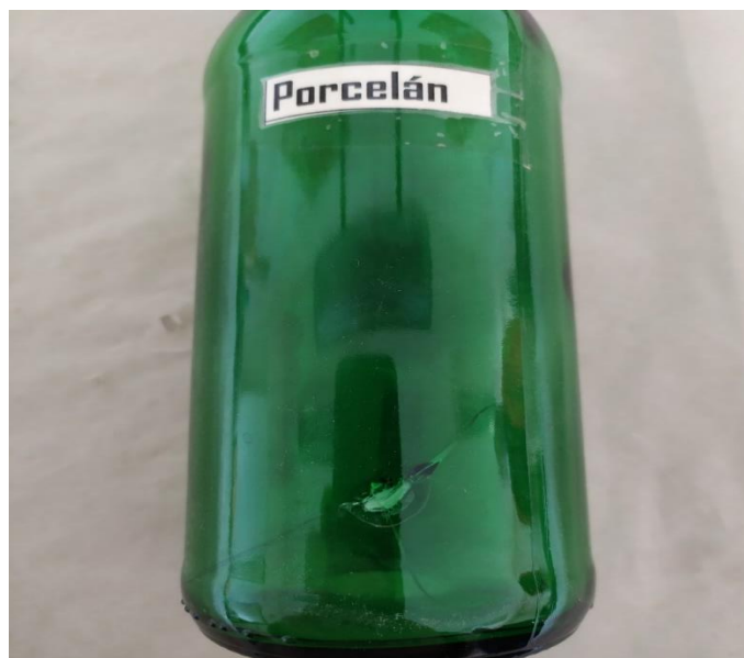
Obrázek 22: Vada způsobená kouskem porcelánu
