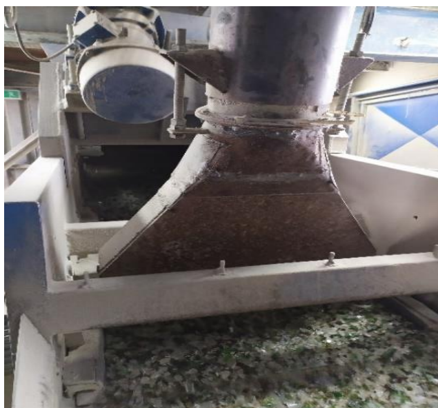
Obrázek 14: Vibrační podavač s cyklónem
