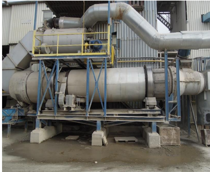
Obrázek 19: Rotační bubnová sušička BS 10
