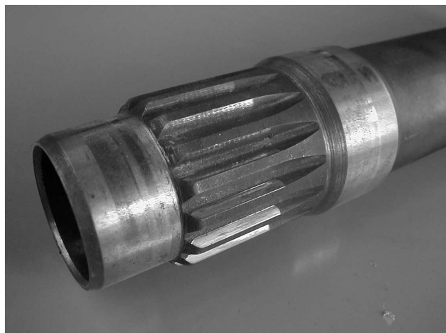
Obr. 14 Vibrační opotřebení drážkového hřídele
