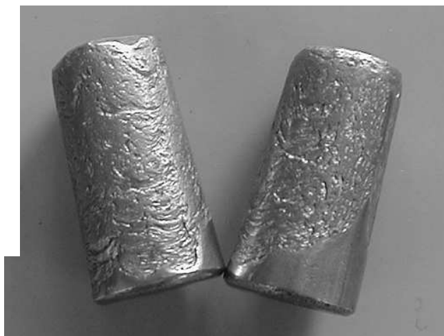
Obr. 11 Princip únavového opotřebení Obr.12 Únavové opotřebení ložiska
