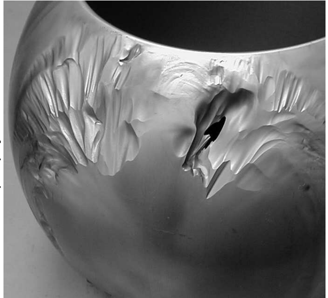
Obr. 5 Princip erozivního opotřebení Obr. 6 Uzávěr potrubí pneumatické dopravy popílku
