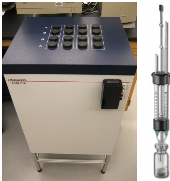
Obr. 25 Vlevo: Izotermický kalorimetr TAM Air [26], vpravo: skleněná ampule s manuálním míchadlem a dvěma 1ml stříkačkami na záměsový roztok [27]
