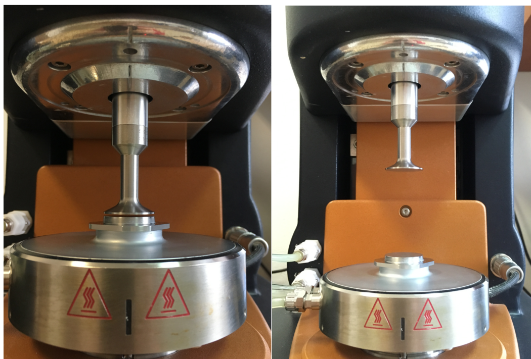
Obr. 24 Vlevo: zkušební geometrie s mezerou 1 mm, vpravo: zkušební geometrie s mezerou 55 mm
