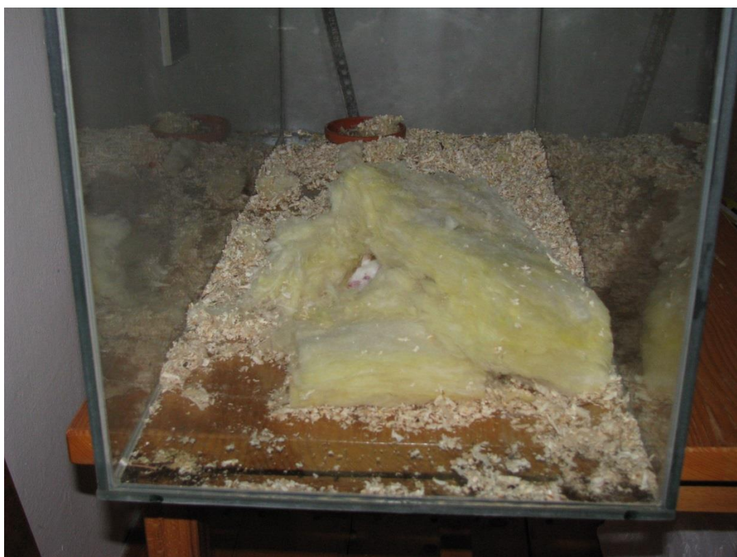
Obr 15. Minerální vata po 7 hodinách rozdělena na polovinu – mocnost 30 mm (Zdroj: vlastní foto)
