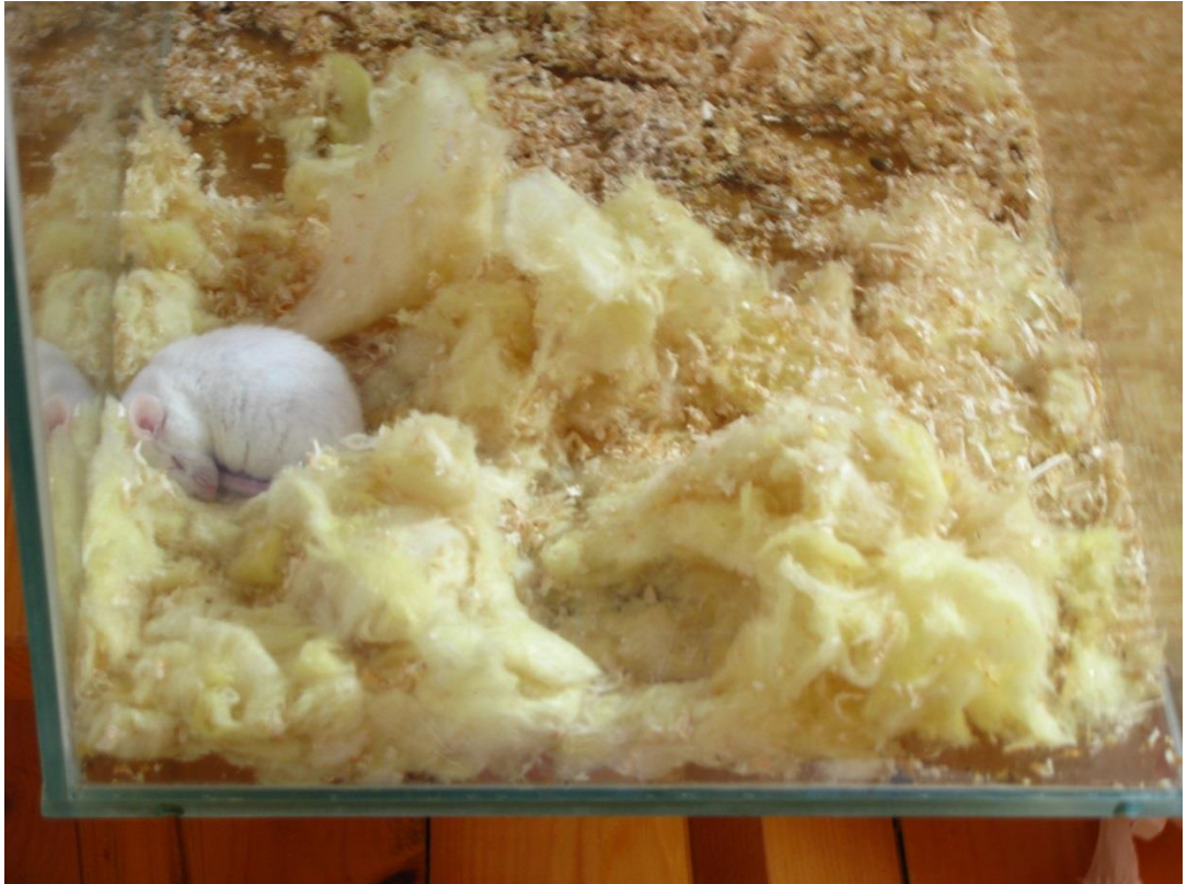
Obr 16. Zbytky minerální vaty po sedmi dnech styku s hlodavcem (Zdroj: vlastní foto)
