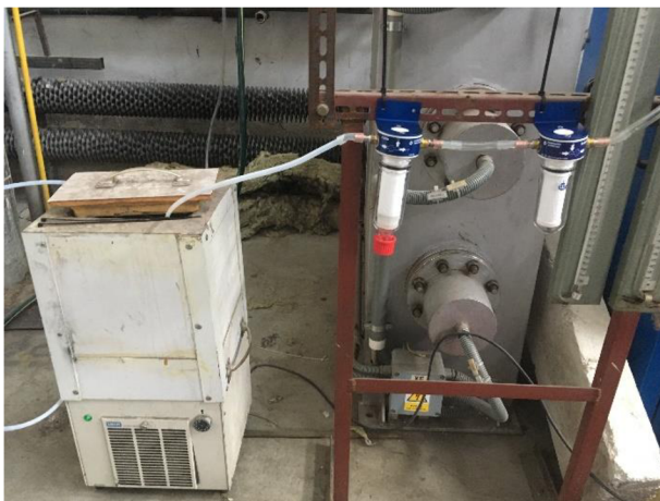
Obrázek 4.6 Čištění plynu před analyzátozem
