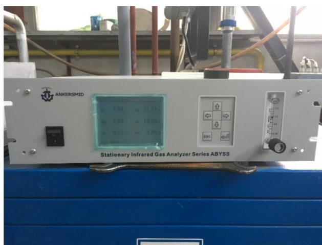
Obrázek 4.5 Online analyzátor plynu Ankersmid ASG 700
