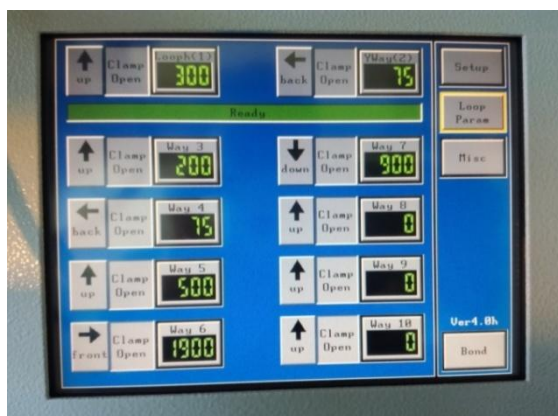
Obr. 14 Nastavenie síl pri kontaktovaní
