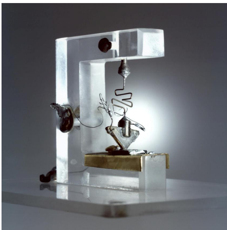
Obr. 1 Prvý tranzistor prepojený s vývodmi pomocou kontaktovania[1]
