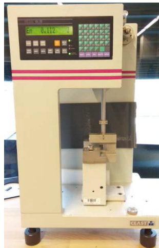
Obr. 3.8 Prístroj na meranie rázovej húževnatosti Resil Ceast 5
