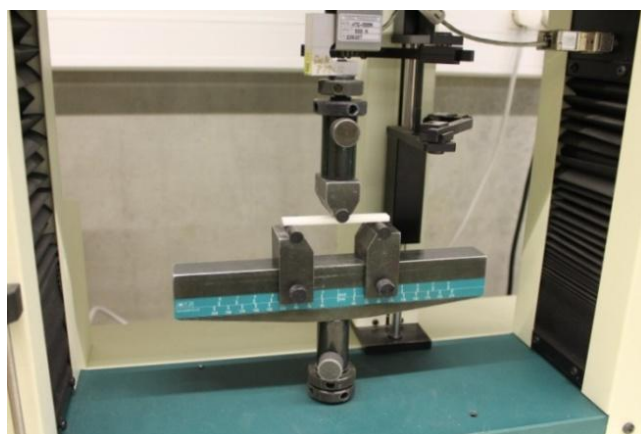
Obr. 3.7 Meranie ohybových vlastností na stroji HOUNSFIELD H10KT [33]
