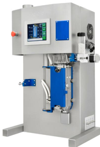
Obr. 3.2 Kompaundér Xplore MC 15 HT [30]
