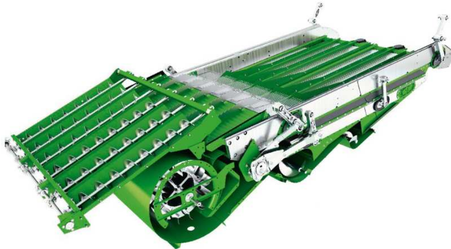
Obrázek 15: Systém čištění modelové řady T [15]
