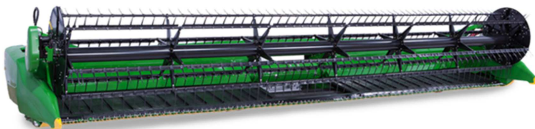
Obrázek 22: Žací adaptér řady 700FD [30]
