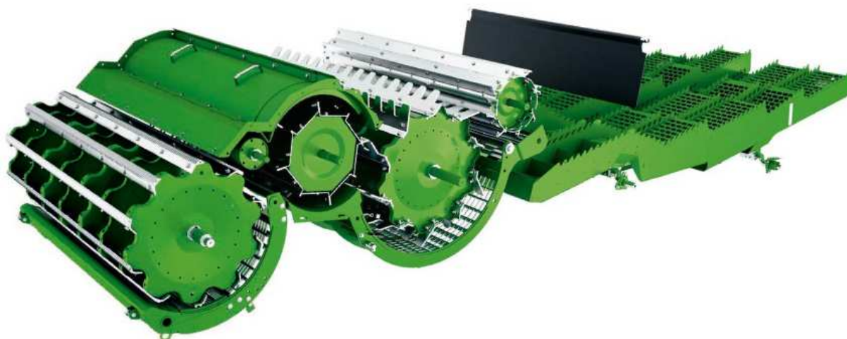
Obrázek 13: Mláticí a separační mechanismus John Deere řady T [15]
