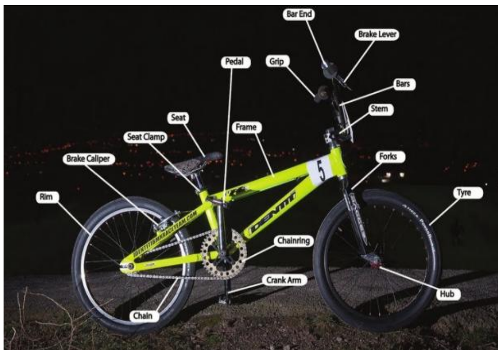
Obrázek 2 Popis závodního bikrosového kola (Jeffries & Thewlis, 2013)
