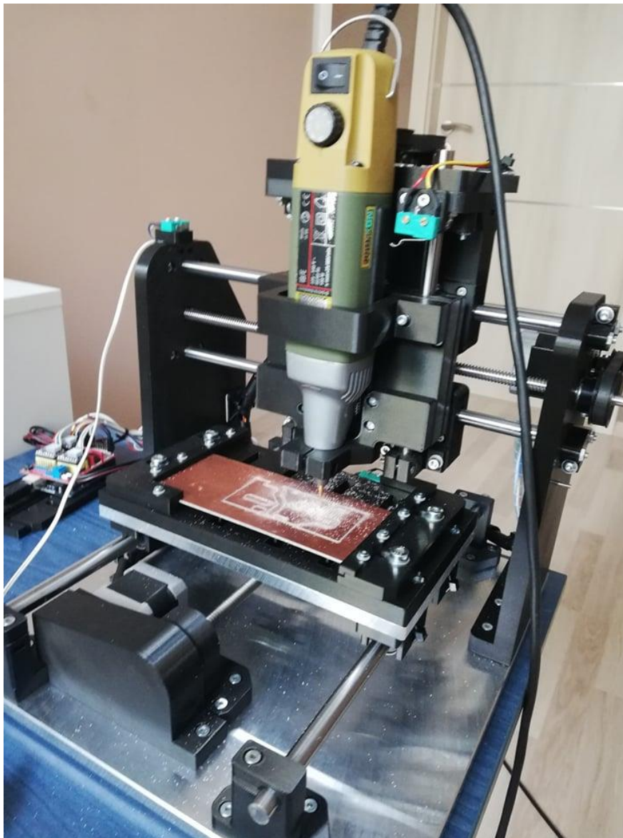
Obr. 71 Testování stroje (frézování DPS)
