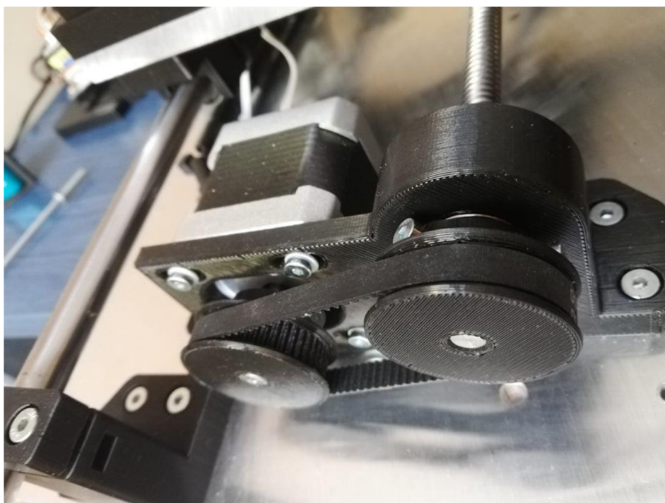
Obr. 35 Spojení trapézového šroubu s motorem
