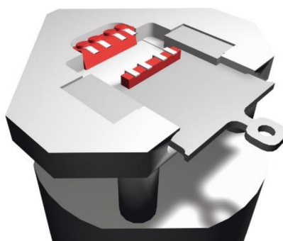
Obr. 2.2 Držák vzorku Scienta Omicron. Převzato z [17].
