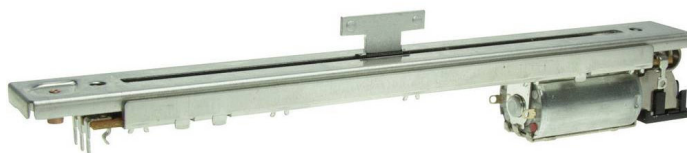
Obrázek 4.1: Motorizovaný potenciometr ALPS RSA0N11M9A0K. Zdroj [5]
