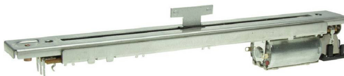
Obrázek 4.1: Motorizovaný potenciometr ALPS RSA0N11M9A0K. Zdroj [5]
