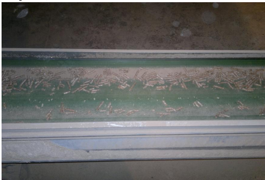
Obr. 16: Hotové pelety na pásovém dopravníku
