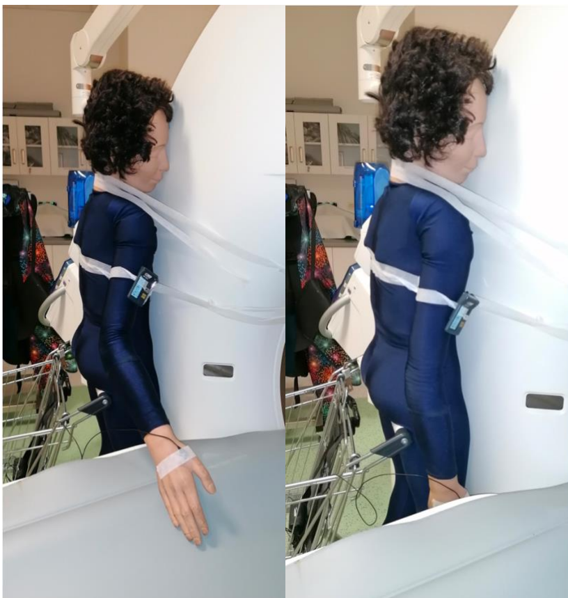
Obrázok č. 10: Umiestnenie antropomorfného fantómu a dozimetrov.
