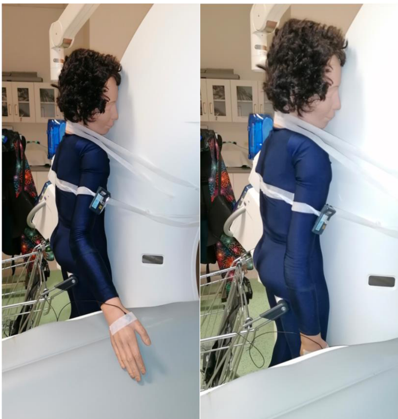
Obrázok č. 10: Umiestnenie antropomorfného fantómu a dozimetrov.
