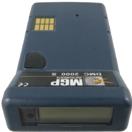
Obrázok č. 8: Osobný dozimeter DMC 2000S.
