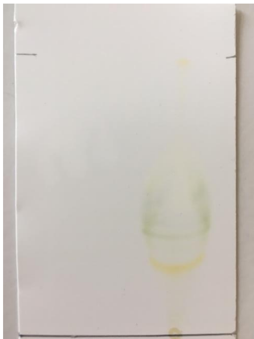
Obrázek č. 7 Chromatogram stanovení rostlinných barviv pomocí tenkovrstvé chromatografie
