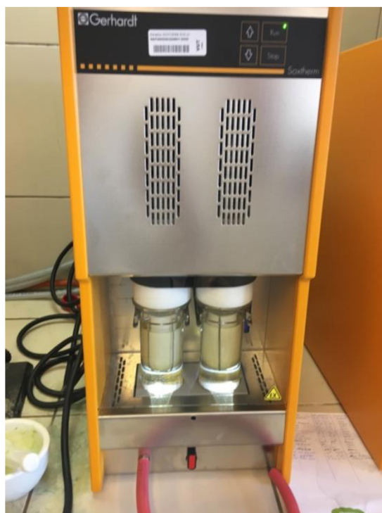
Obrázek č. 3 Automatický extraktor Soxterm firmy Gerhart (Neměcko)
