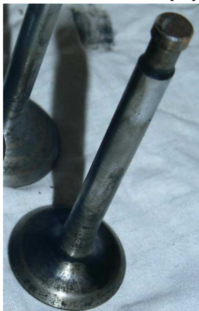
Obrázek 3: Ventil, na kterém je vidět třecí plocha dříku z motoru Škoda 120L
