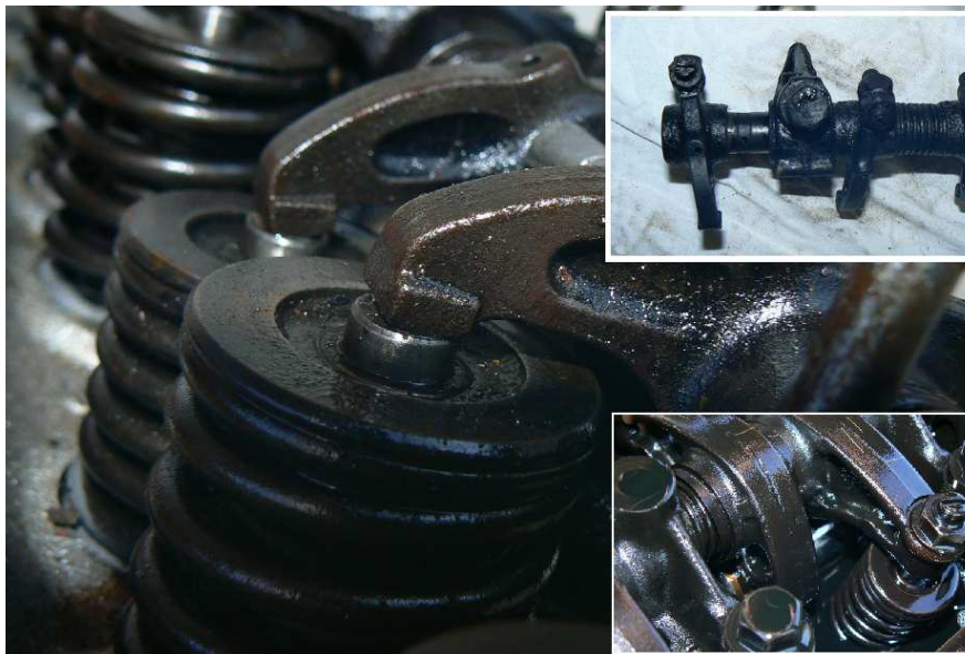
Obrázek 4: Znárodnění dotykových ploch mezi vahadlem, koncem dřívku, vačkou a čepem vahadla u motorů Škoda 110R a Citroen AX
