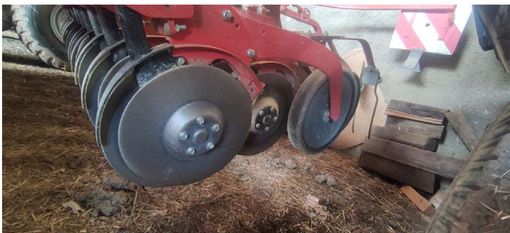
Obrázek 4: Disková secí botka se zavlačovačem
