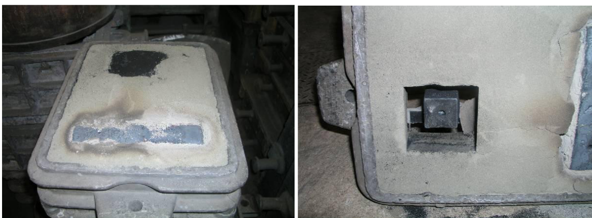
Obr. 6.1 cementová forma s bentonitovou „kapsou“ po odlití
