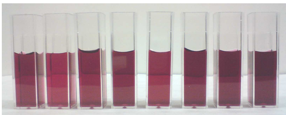
Obr. 18: Zabarvení roztoků nanočástic zlata připravených s rostoucí koncentrací PEG (koncentrace PEG roste zleva doprava)
