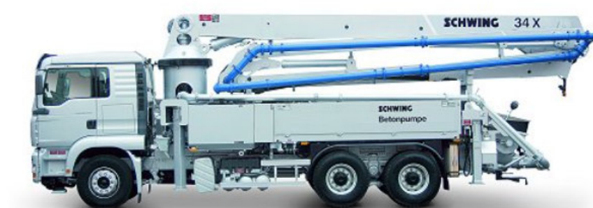
Obr. č. 17: Autočerpadlo SCHWING S34X
