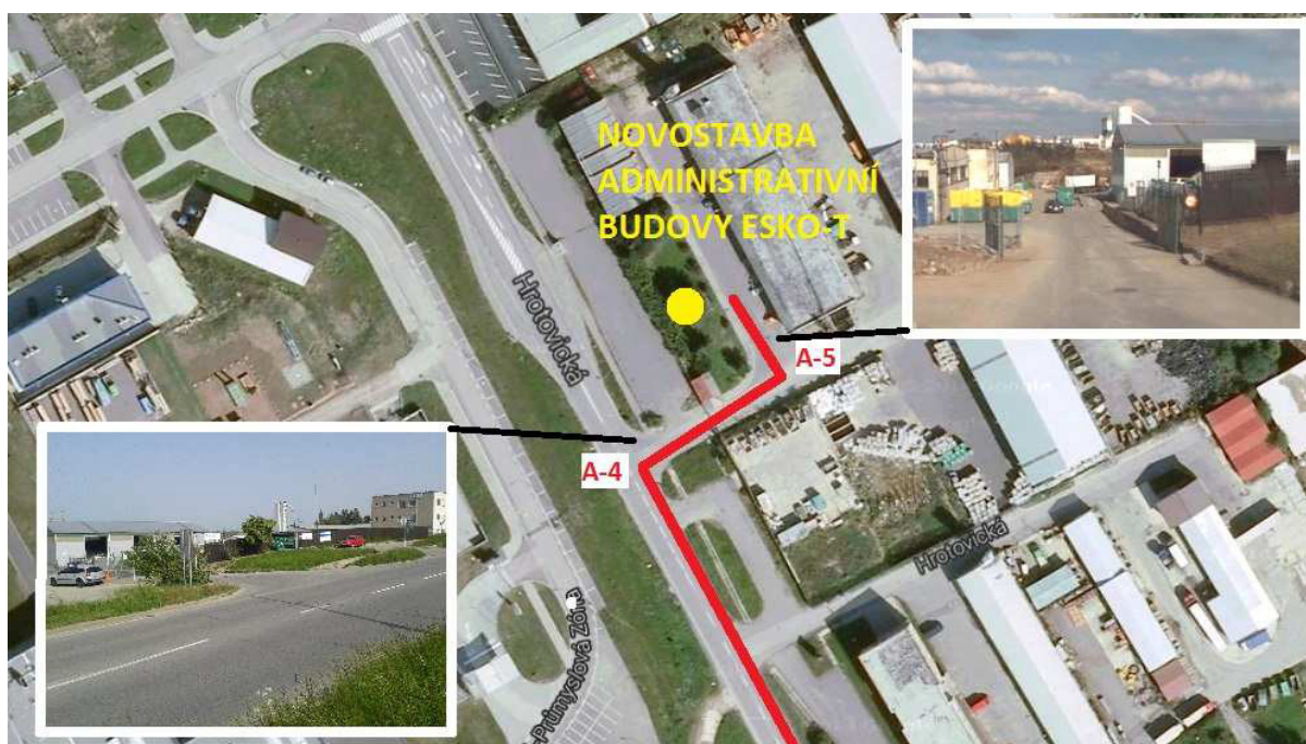
A-4 + A5 - Přejezd ke staveništi: Sjezd z ulice Hrotovická vyhovuje potřebnému poloměru otáčení 10 m. Potřebnému poloměru otáčení 10 m vyhovuje i přjezd k samotné realizované stavbě.
