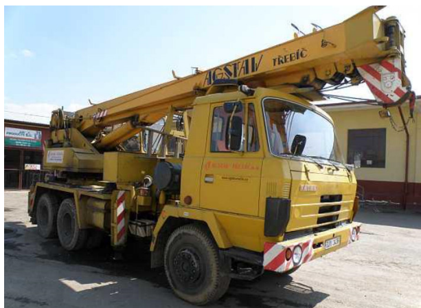
Obr. č. 11: Autojeřáb T 815 AD 20T
