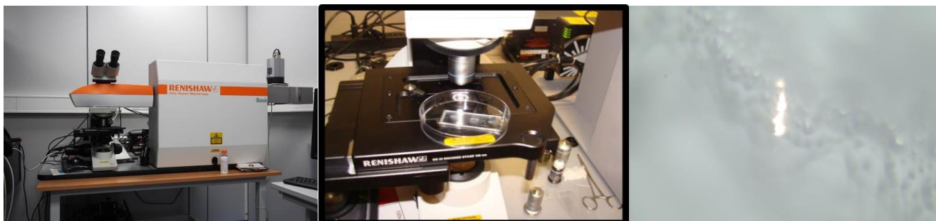
Obr. 8 Z ľava na obrázku je zachytený Ramanov spektrometer Renishaw využívaný v experimentálnej časti práce, následne detail na meracej doske pri samotnom meraní vzoriek a stopa plochy laseru pri meraní
