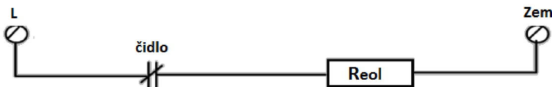
Obr. 4.3 Zapojení PIR s EOL rezistorem
