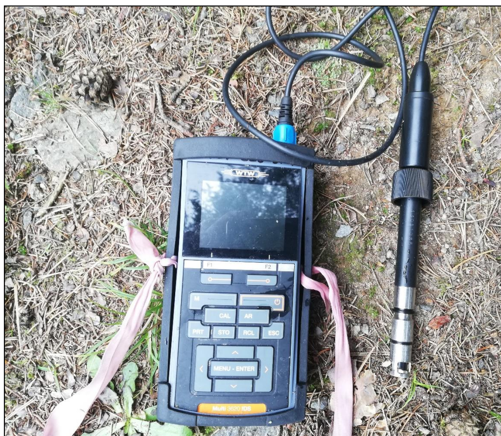
Příloha 6: Multimetr WTW použit k měření rozpuštěného kyslíku, foto vlastní
