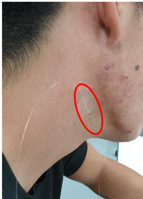
Obr. 23 FBG senzor umístěný na krku
