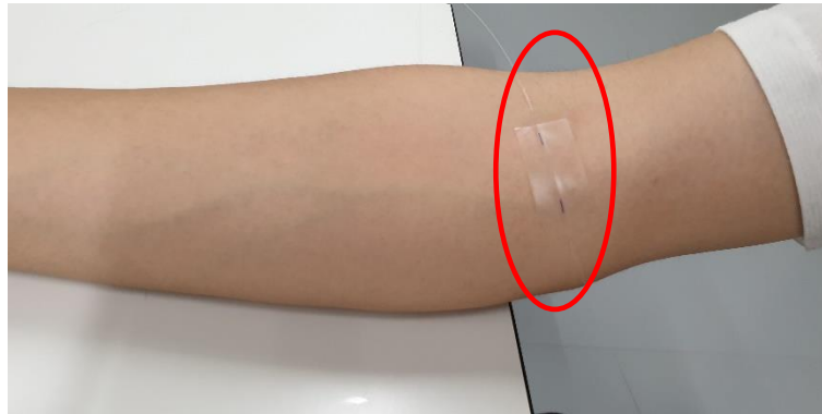
Obr. 22 FBG sezor umístěný na paži
