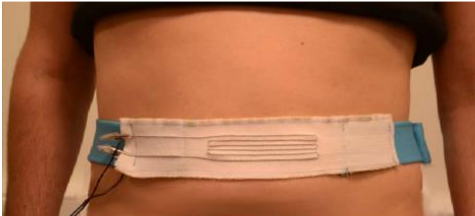
Obr. 9 Senzor vpletený do struktury pásu [5]
