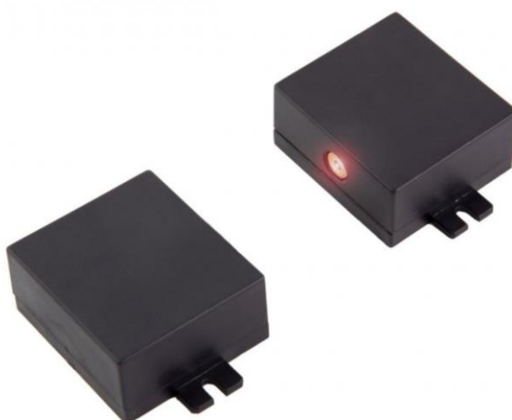
Obrázek 16 - Paprsková závoru (stavebnice)
