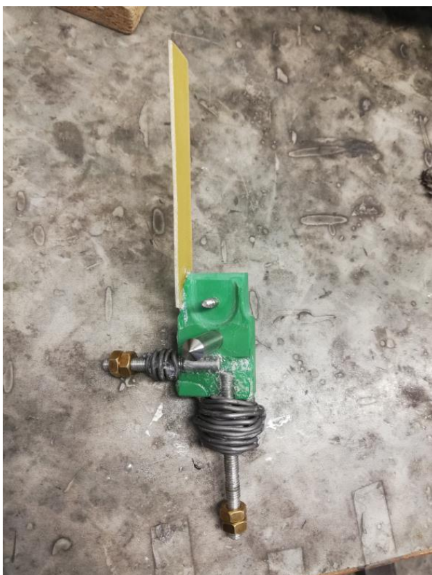
Obrázek 44 Přípravek pro vyvažování jednotlivých listů
