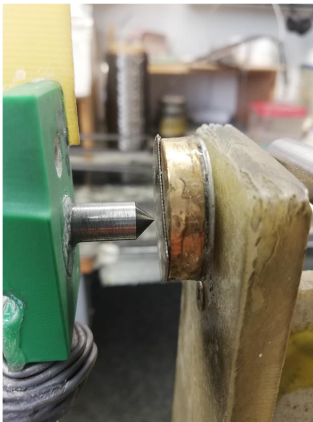
Obrázek 43 Detail vazby kolík – magnet
