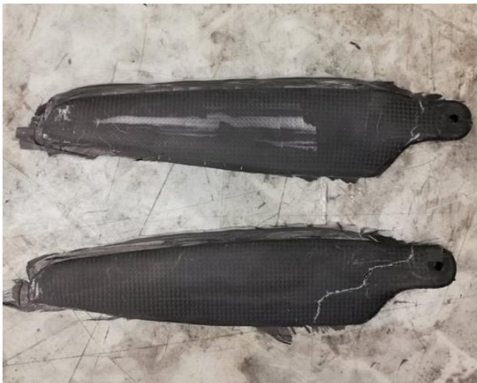
Obrázek 42 První, neúspěšný pokus výroby listů vrtule
