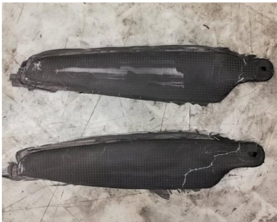
Obrázek 42 První, neúspěšný pokus výroby listů vrtule
