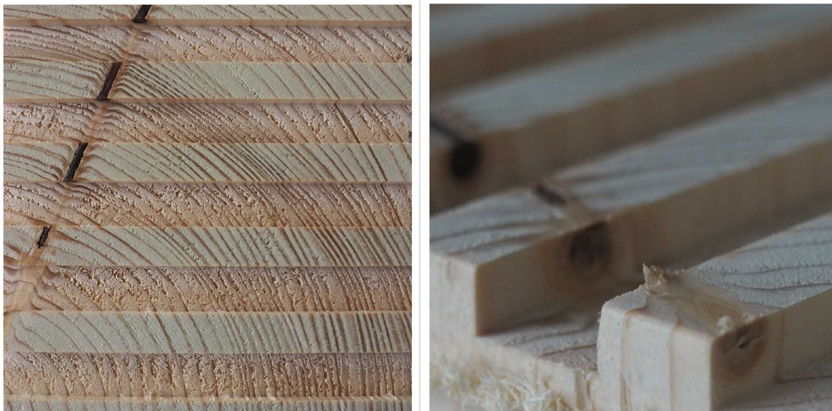
Obr. 6.2 Kvalita obrobeného povrchu na příčném řezu s vadou.
