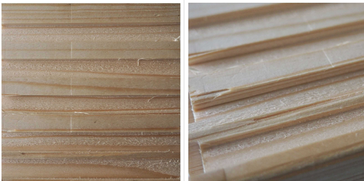
Obr. 6.3 Kvalita obrobeného povrchu podél vláken.
