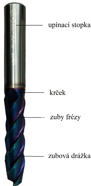
Obr. 2.13 Univerzální fréza.
