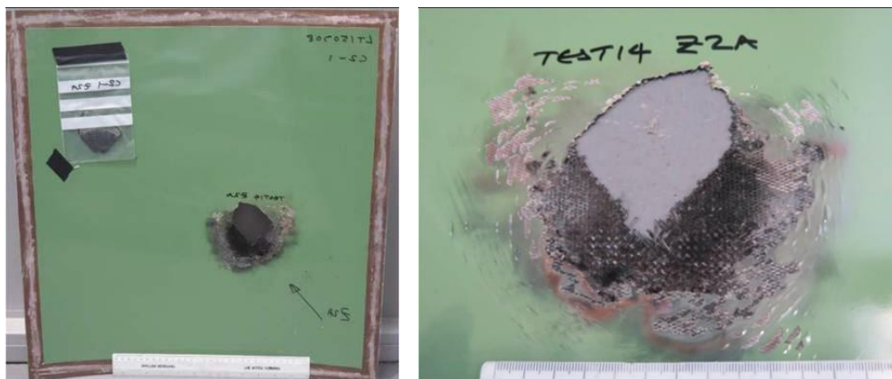
Obr. 3.18: Zkušební panel s ochrannou měděnou mřížkou po zásahu bleskem: rozsáhlé poškození v místě připojení úderu blesku v zóně 2A.
